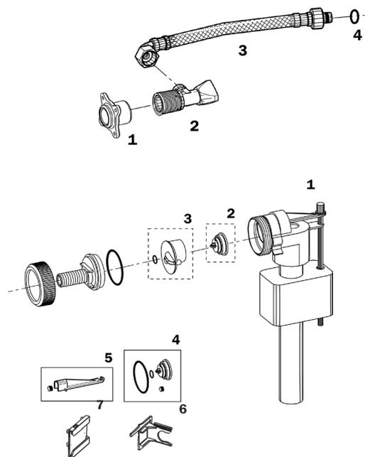
**Заливной вентиль с клапаном для бачка 8 см**
