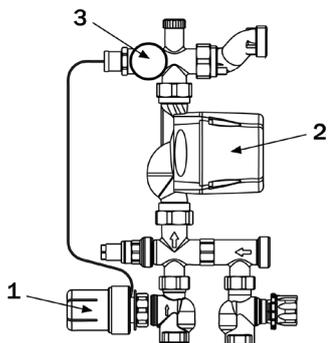
**Насосно-смесительный узел для поверхностного отопления (арт. 7745 00 00)**
