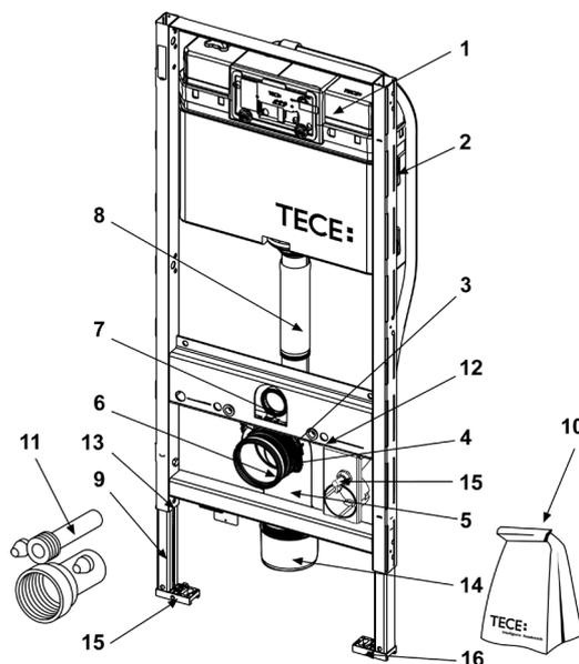
**9 300 031 – застенный модуль (h = 1120 мм) для установки подвесного унитаза, фронтальное расположение панели смыва**
