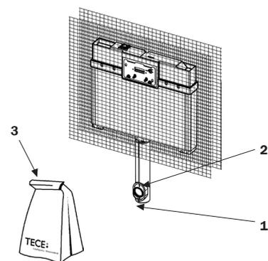
**9 370 000 – застенный модуль для установки подвесного унитаза, фронтальное расположение панели смыва**
