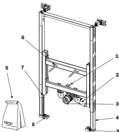
**9 330 005 – застенный модуль (h = 820 мм) для установки подвешного биде**
