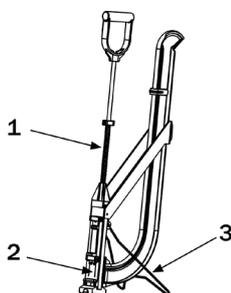
**Инструмент для монтажа якорных скоб (арт. 7761 00 10)**
