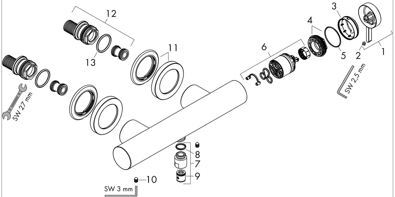
**Finoris****Смеситель для душа, однорычажный, внешнего монтажа**Поверхность: **хром** Артикульный номер: **76620000**
