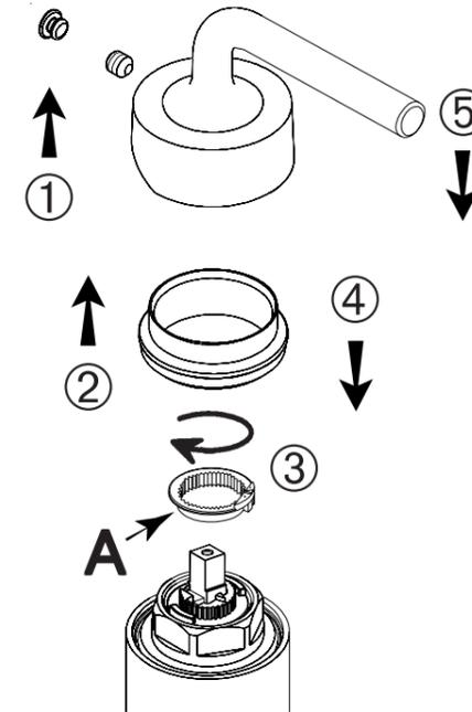
(F) Une bague-limiteur de température (A), clipsée sur la cartouche, permet de limiter le déplacement du levier vers la gauche, et de diminuer ainsi la température de l'eau chaude. (selon ①②③④⑤)
