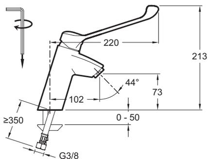
Спецификация продукта : Смеситель для раковины Panache, без донного клапана. E18162. Коллекция : EASY. ВЕС : 1.5 кг. МАТЕРИАЛ : N/A. TYPE : Однорычажный. DÉBIT (L/MN SOUS 3 BARS) : 13 л/мин. RACCORDS : С гибкой подводкой. MÉCANISME : Последовательный керамический картридж. VIDAGE : Non. MITIGEUR DE BAIN : 0. TYPE D'INSTALLATION : 1 отверстие. GARANTIE FINITION : 0. Простая установка коленного соединения (на уровне 150 мм).
