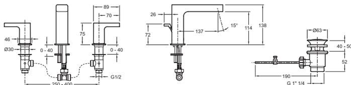
Спецификация продукта : Смеситель для раковины на три отверстия. E37331. Коллекция : STRAYT. ВЕС : 4.3 кг. МАТЕРИАЛ : N/A. ТИП УСТАНОВКИ : 3 отверстия. TYPE : Двурывчажный. DÉBIT (L/MN SOUS 3 BARS) : 5 л/мин. HAUTEUR TOTALE DU ROBINET (MM) : 138. SAILLIE DU BEC (MM) : 137. RACCORDS : С гибкой подводкой. MÉCANISME : Керамические кран-буксы. VIDAGE : С донным клапаном. GARANTIE FINITION : 10 лет. Металлический донный клапан. Отверстия: 30, 35, 30 мм.
