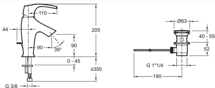
Спецификация продукта : Смеситель на одно отверстие с донным клапаном. E72680. Коллекция : SYMBOL. ВЕС : 1.3 кг. МАТЕРИАЛ : N/A. ТИП УСТАНОВКИ : 1 отверстие. TYPE : Однорычажный. DÉBIT (L/MN SOUS 3 BARS) : 14 л/мин. HAUTEUR TOTALE DU ROBINET (MM) : 90 мм. SAILLIE DU BEC (MM) : 90 мм. RACCORDS : С гибкой подводкой. MÉCANISME : Керамический картридж. VIDAGE : С донным клапаном. GARANTIE FINITION : 10 лет. Роскошь, элегантность и легкость. Скрытая насадка с антиизвестковым покрытием, антивсплеск.
