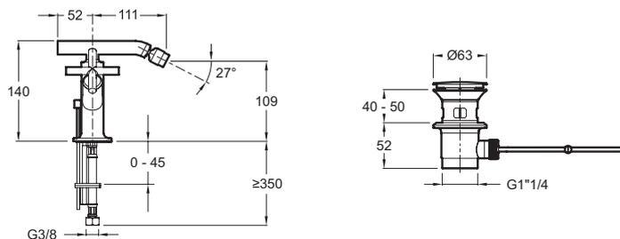
Спецификация продукта : Смеситель для биде на одно отверстие с донным клапаном. E14596-3. Коллекция : PURIST. ВЕС : 2.4 кг. МАТЕРИАЛ : N/A. ТИП УСТАНОВКИ : 1 отверстие. TYPE : Двурыважный. HAUTEUR TOTALE DU ROBINET (MM) : 109 мм. SAILLIE DU ВЕС (MM) : 111 мм. MÉCANISME : Кран-бухсы с керамическим диском. VIDAGE : С донным клапаном. GARANTIE FINITION : 10 лет.
