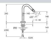
Спецификация продукта: Смеситель для биде. E971-4. Коллекция: STILLNESS. BEC: 1.9 кг. МАТЕРИАЛ: N/A. ТИП УСТАНОВКИ: 1 отверстие. TYPE: Однорычажный. DÉBIT (L/MN SOUS 3 BARS): 6 л/мин. HAUTEUR TOTALE DU ROBINET (MM): 149. SAILLIE DU BEC (MM): 145. MÉCANISME: Последовательный керамический картридж. VIDAGE: Без донного клапана. GARANTIE FINITION: 10 лет. Аэратор с антиизвестковым покрытием.
