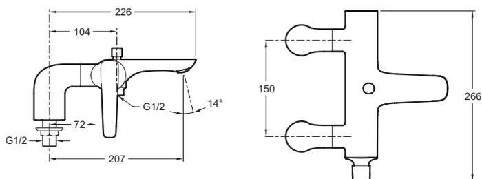
Спецификация продукта : Однорычажный смеситель для ванны/душа, E72320. Коллекция : ALEO+. ВЕС : 3 кг. МАТЕРИАЛ : N/A. TYPE : Однорычажный. DÉBIT (L/MN SOUS 3 BARS) : 26 л/мин. SAILLIE DU BEC (MM) : 208 мм. MÉCANISME : Керамический картридж. ENTRAXE (MM) : 150 ± 15 мм. VIDAGE : Non. TYPE DE ROBINETTERIE DE CUISINE : Механика. MITIGEUR DE BAIN : МЕХАНИКА. TYPE D'INSTALLATION : На борт ванны. GARANTIE FINITION : 10 лет.
