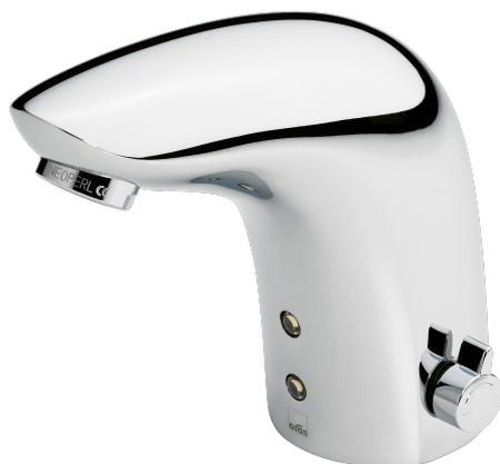
Бесконтактный смеситель для умывальника с регулировкой температуры. Может быть легко модифицирован для работы с предварительно заданной температурой или для использования предварительно смешанной воды. Оснащен грязевыми фильтрами и обратными клапанами. При установке настройка параметров не требуется. Датчик с системой автофокуса. Ограничитель расхода воды (6 л/мин)- экономия воды (до 0.5 л при однократном использовании). Работает от трансформатора 230/12В
