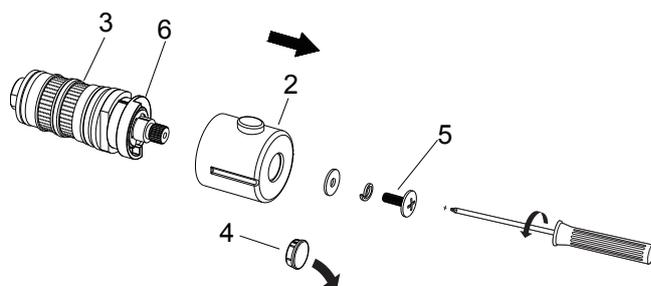
3. Соберите картридж (3), установите его обратно на корпус смесителя, закрутите шестигольную гайку торцевым ключом, наденьте стопорное кольцо (6) обратно на картридж (3) и закрепите ручку, закрутив винт.
