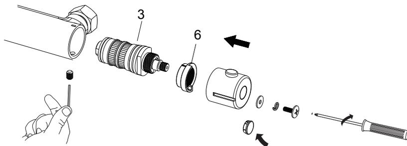
Предупреждение 1: Только при совпадении двух черных линий, отмеченных (a) и (b), температура будет равна  $38 \pm 2$  С.
