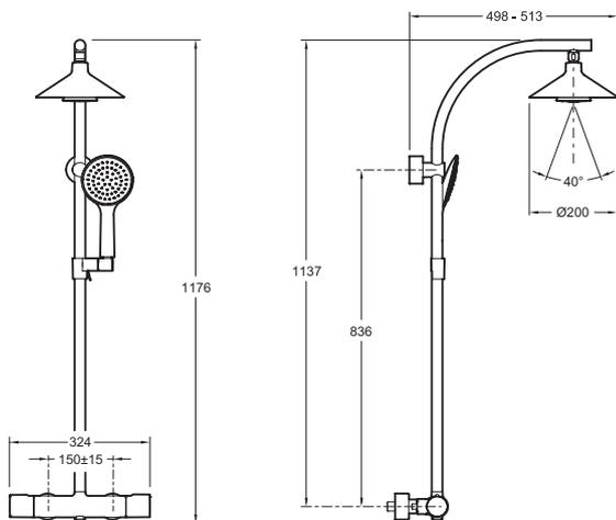
Спецификация продукта : Душевая колонна с термостатическим смесителем. E5799. Коллекция : MOXIE. ВЕС : 7 кг. МАТЕРИАЛ : N/A. ТИП УСТАНОВКИ : Крепление к стене. TYPE D'ACCESSOIRE : 0. AVEC OU SANS ROBINETTERIE : CO СМЕСИТЕЛЕМ. MITIGEUR : ТЕРМОСТАТИЧЕСКИЙ. TYPOLOGIE DE ROBINETTERIE DE DOUCHE : ТЕРМОСТАТИЧЕСКИЙ. FORME DE LA DOUCHE DE TÊTE : КРУГЛЫЙ. INVERSEUR : 0. TYPE DE FLEXIBLE : Нескручивающийся. NOUVEAUTÉ : 0. Выпускное отверстие с антиизвестковым покрытием.
