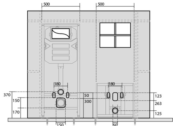
**9184** Mobile pannello in legno 90x140x17 completo di struttura per wc sospeso e cassetta di scarico priva di placca
