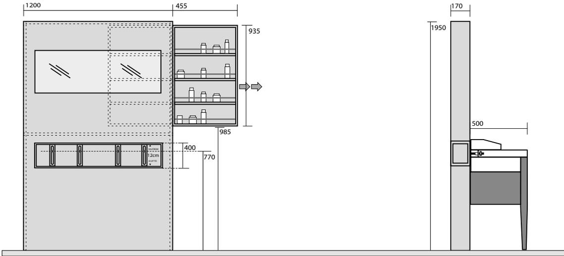
**9172** Mobile pannello in legno 140x195x17 con estraibile e struttura di fissaggio per lavabo
