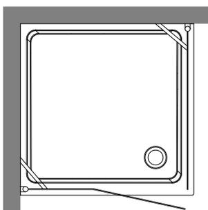
**9149** Cabina doccia DX con porta battente e fisso laterale per piatto doccia angolare 100x100 quadro. Apertura utile 54 cm, altezza 180 cm. Right shower enclosure with door for corner shower-tray 100x100. Usable opening 54 cm, height 180 cm.
