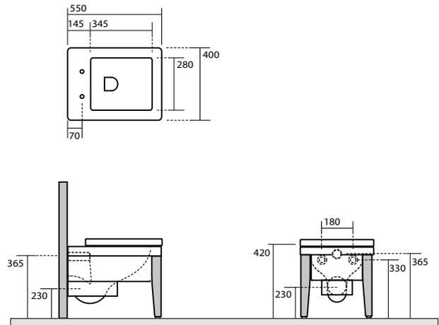
**9185** Mobile pannello in legno 152x140x17 completo di struttura per wc e bidet sospesi e cassetta di scarico priva di placca
