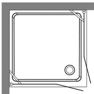
**9148** Cabina doccia DX/SX a due porte battenti e fisso in linea per piatto doccia 100x100 quadro. Apertura utile 36 cm per anta, altezza 180 cm. Reversible shower enclosure with two doors for corner shower-tray 100x100. Usable opening 36 cm, height 180 cm..
