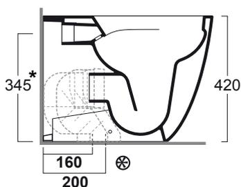
Curva tecnica per lo scarico a pavimento regolabile da 16 a 20 cm
