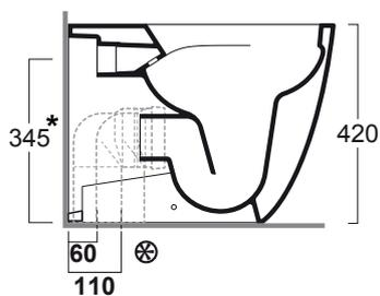
Curva tecnica per lo scarico a pavimento regolabile da 6 a 11 cm
