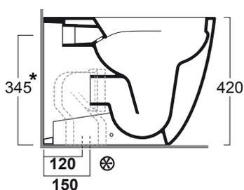
Curva tecnica per lo scarico a pavimento regolabile da 12 a 15 cm
