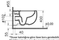
\*Duvar kalınlığına göre ilave boru gerekebilir. \*Additional pipe may be required due to wall thickness \*Ein zusätzliches Ablaufrohr ist je nach Wandstärke erforderlich
